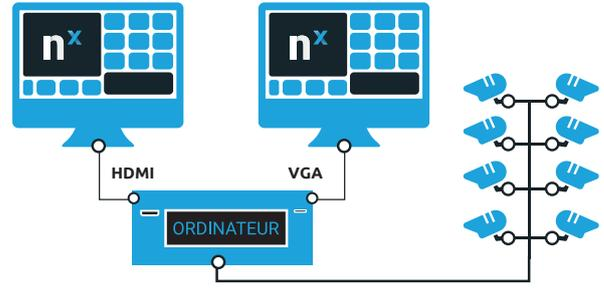
En plus de faire office de client, l'ordinateur sert de serveur, et gère donc l'encodage et l'enregistrement (sur disque optionnel ou NAS). Il ne devra être éteint sous aucun prétexte (mode expert uniquement).
