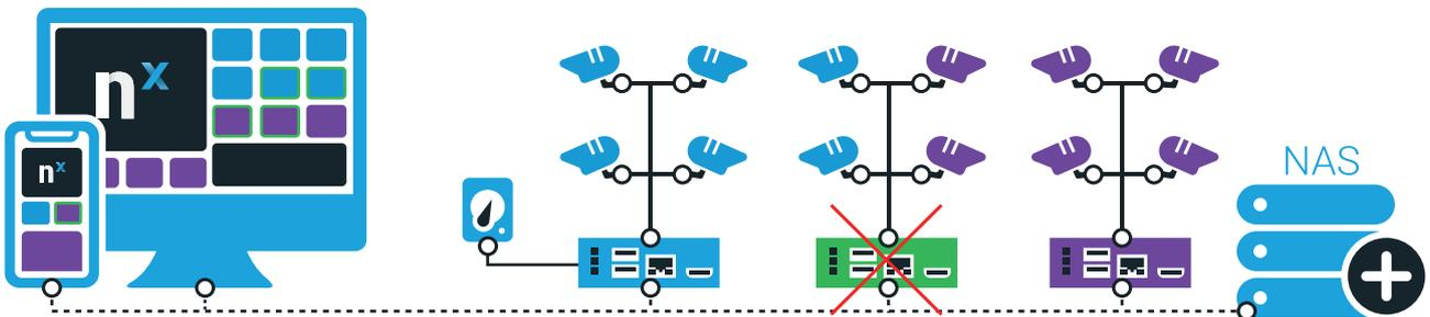
Sur une installation de plusieurs caméras sur plusieurs serveurs, lorsque que l'un des serveurs est défaillant, les autres prennent automatiquement le relais et se partagent les caméras afin de continuer l'enregistrement et le stockage des caméras connectés initialement à ce serveur défaillant.
