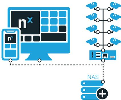
Une installation de plusieurs caméras sur un seul serveur, accessible sur PC et smartphone, avec un stockage possible sur un NAS
