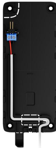
5. Mettez le clavier sous tension et placez-le sur le panneau de montage.
