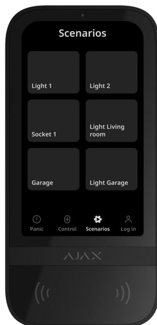
L'onglet séparé du clavier peut contenir jusqu'à six boutons pour le contrôle d'un seul dispositif d'automatisation ou d'un groupe de dispositifs. Les scénarios de groupe de dispositifs permettent de gérer simultanément plusieurs interrupteurs, relais ou prises.
