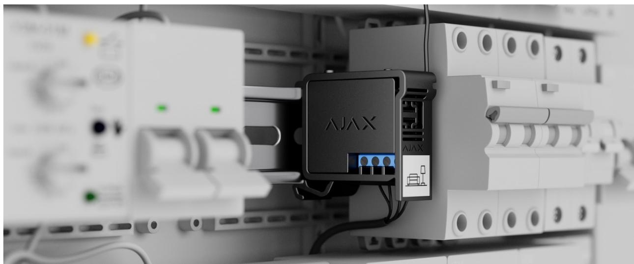
Le dispositif mesure 39 × 33 × 18 mm et est connecté au circuit électrique. Grâce à sa taille, le relais peut être placé dans une prise encastrée, un boîtier d'appareil électrique ou un tableau électrique. Une antenne externe flexible assurera la stabilité des communications. Nous recommandons d'utiliser le DIN Holder pour fixer le Relay sur un rail DIN.
