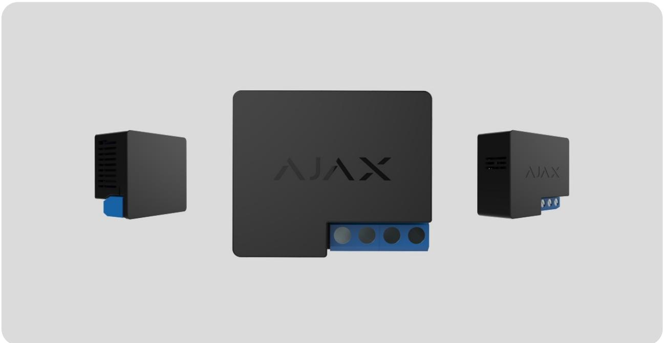
**Relay** est un relais avec contact sec sans potentiel pour la télécommande de l'alimentation. Le relais est doté d'un contact sec, qui n'est pas relié galvaniquement au circuit d'alimentation de l'appareil. Cela permet d'utiliser Relay aussi bien dans les réseaux électriques basse tension que dans les réseaux domestiques. Le dispositif est doté de deux types de protection : contre la surtension et contre la surchauffe.
